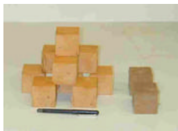
Photo : Boue stabilisée au moyen de ciment Portland
